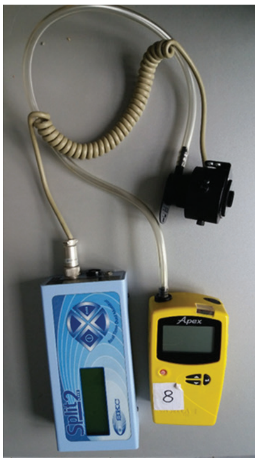
Slika 4. Mjerni uređaj za fotometrijsko određivanje masene koncentracije lebdećih čestica
